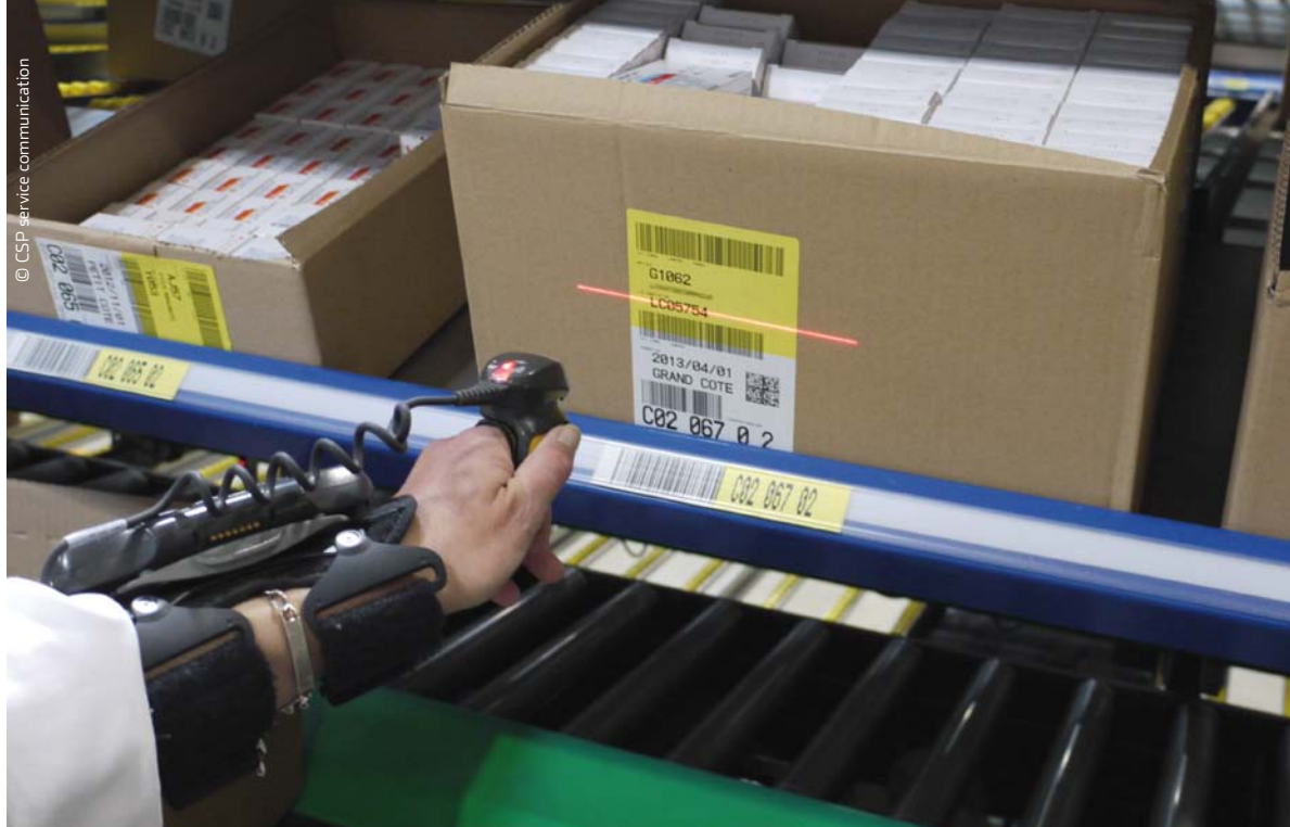
Équipement d'un écran au poignet et d'un lecteur au doigt pour les salariés CSP.
